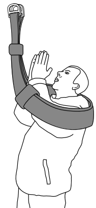
Einstieg bei geschlossener Rettungsschlinge
